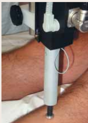
Figur 1. Apparat til at undersøge musklernes smertesensitivitet til mekanisk tryk. Trykket appliceres på musklen ved en aktuator, der computerkontrolleres, således at trykintensitet og tidsmæssige parameter kan styres med stor nøjagtighed.
