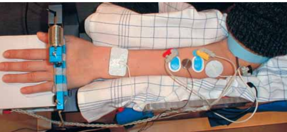
Ekstensor musklernes elektriske signal bliver registreret ved hjælp af de to lyseblå elektroder. Muskellyden måles med accelerometeret mellem de to elektroder. De to hvide elektroder bruges til at stimulere musklen i forbindelse med registrering af muskeltræthed.
