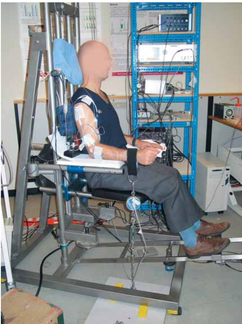
Ekstensor musklernes elektriske signal bliver registreret ved hjælp af de to lyseblå elektroder. Muskellyden måles med accelerometeret mellem de to elektroder. De to hvide elektroder bruges til at stimulere musklen i forbindelse med registrering af muskeltræthed.
